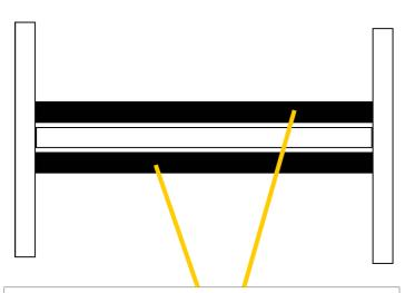
Quadri da 70 cm. In nero da saldare tra la parte anteriore e la parte posteriore lasciando un po' di spazio in più per fare muovere il braccio basculante che sostiene il movimento centrale.
